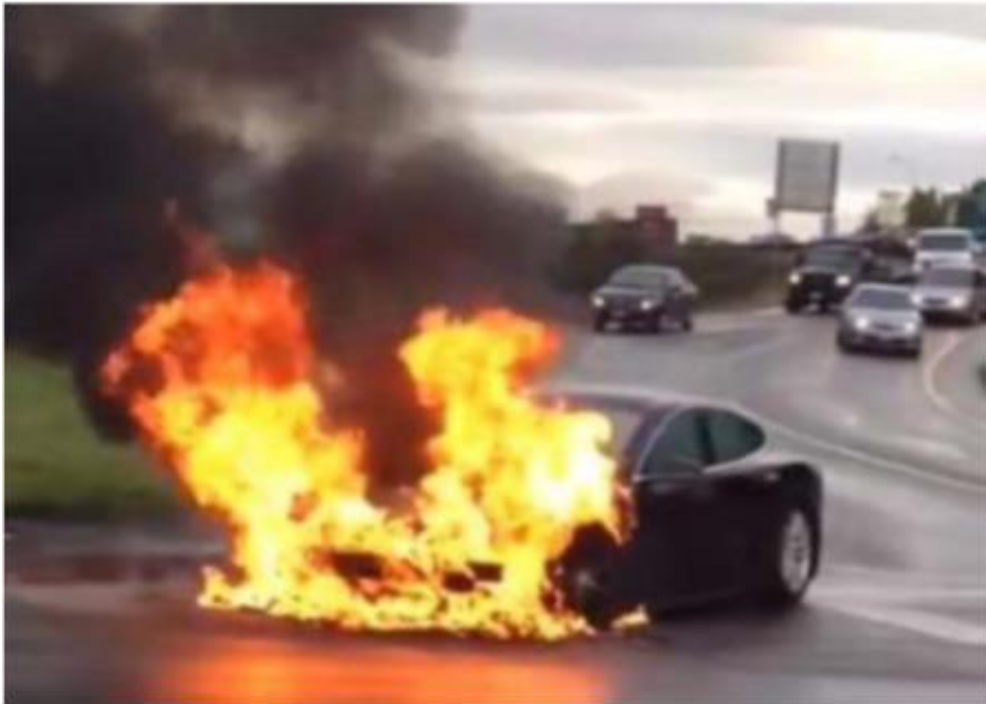
Слика 26. Опожарено возило на Tesla од моделот S поради оштетување на батериите што довело до краток спој
