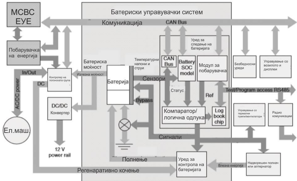
Слика 23. Заштита и контрола на батерии кои се применуваат кај возилата кои се погонуваат на електрична енергија
