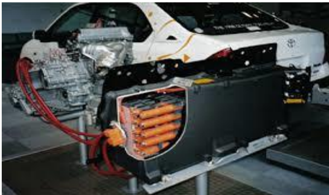
Слика 11. NiMh батерии вградени во ХЕВ на Тојота
