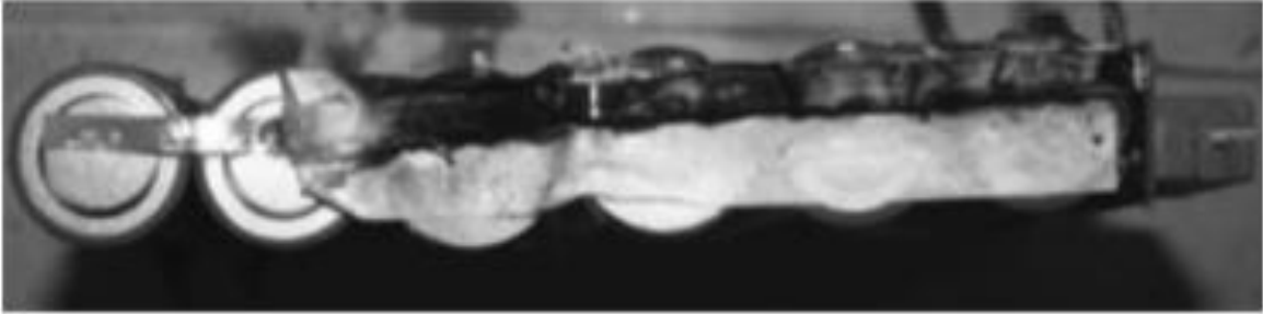
Слика 18. Надворешен краток спој на повеќе ќелиска литиум – јонска батерија
