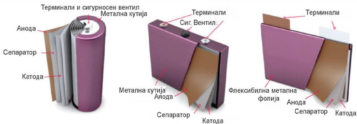
Слика 15. Различни видови формати на ќелии: Цилиндрична и призматична литиум – јонска батерија
