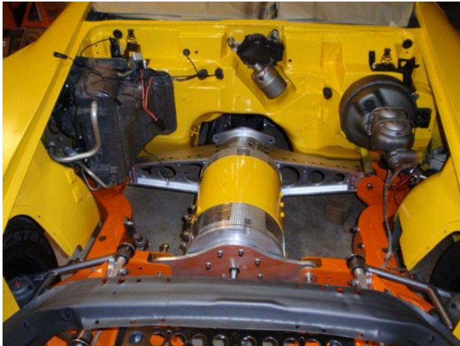
Слика 5. Електричен мотор поставен во просторот под поклопецот на моторот, се забележува прилично голем ослободен простор во споредба со Мотор СВС
