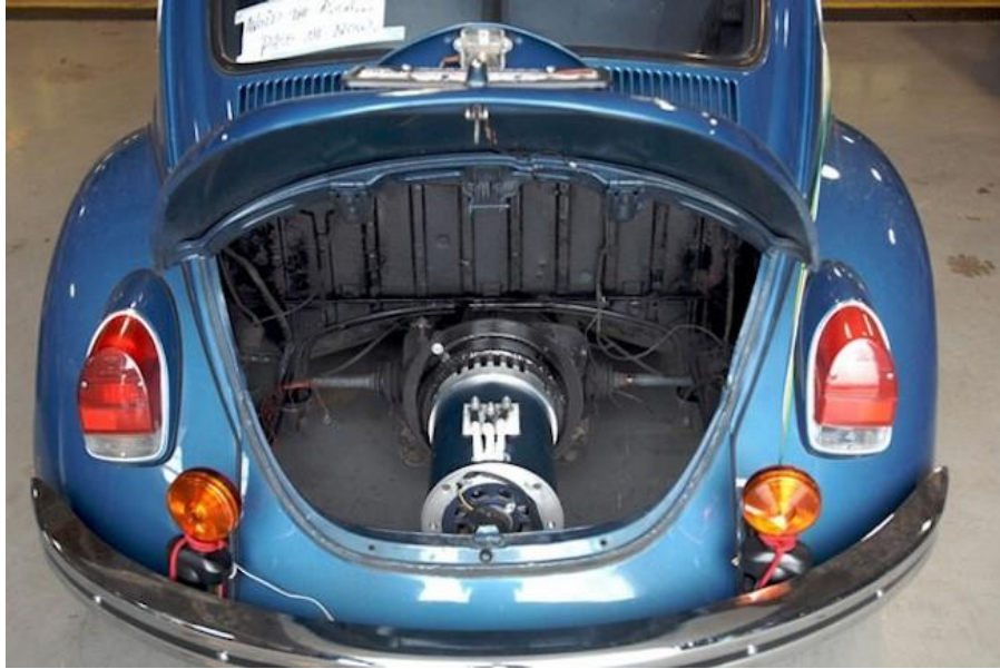
Слика 4. Електричен мотор кај VW Beetle поставен директно на менувачот каде што вообичаено е поставен моторот со внатрешно согорување
